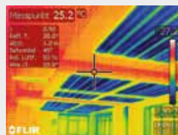
Распределение холода в панелях серии Zehnder PAM
