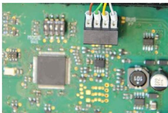
4. Соедините съемную часть с основной частью штекерного соединения коммутационного кабеля.
