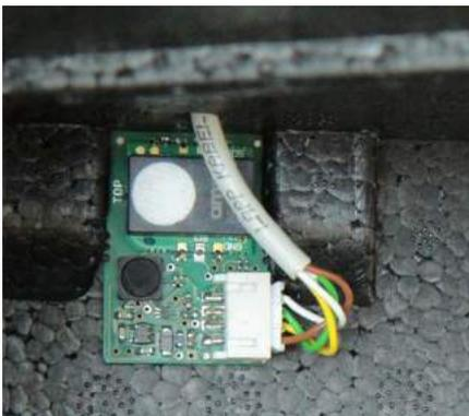
3. Установите верхнюю часть корпуса вентиляционной установки на место. Протяните коммутационный кабель, используя специальную канавку в корпусе вентиляционного блока, до платы управления.
