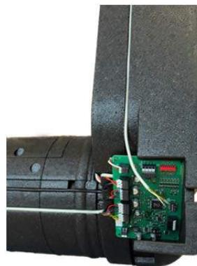
4. Подключите жилы коммутационного кабеля к разъему SENSOR X8 платы управления.
