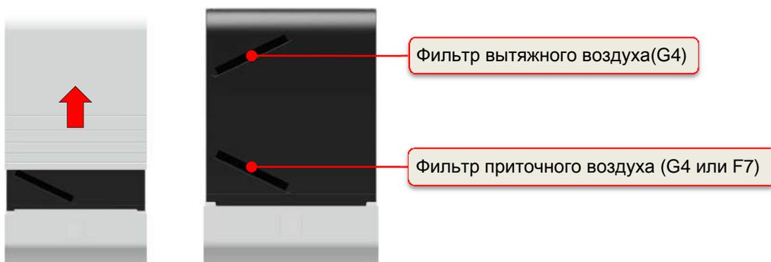
3. Снимите крышку фильтра, потянув ее на себя. Для удобства захвата крышки фильтра в корпусе вентиляционной установки предусмотрено небольшое углубление.
