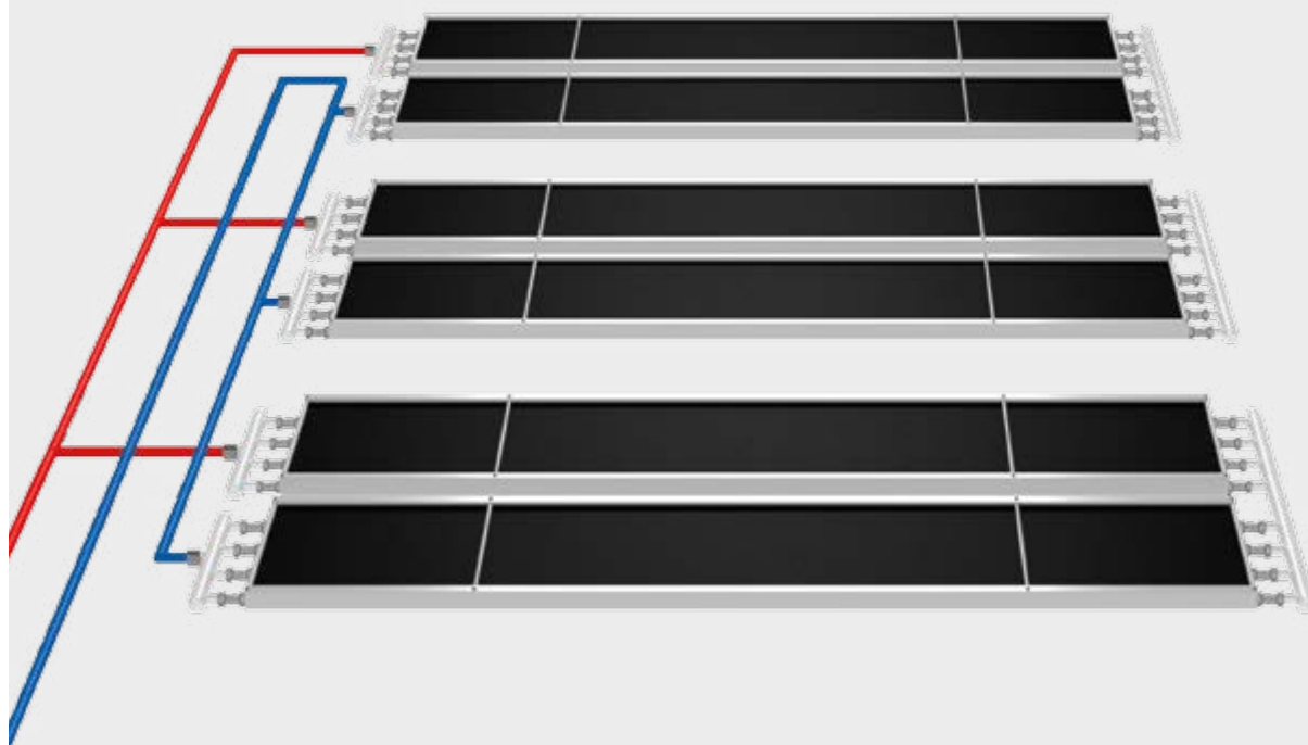
Рис. 1: Прокладка труб по схеме Тихельмана
